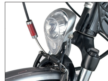
Top: Der Scheinwerfer am Premio SL besitzt eine Standlichtfunktion.
