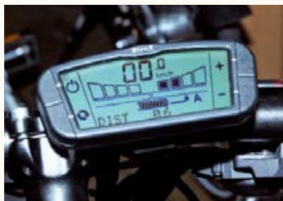
Die neue BionX-Bedienkonsole überrascht mit Nachtlicht und schönen Tasten (Handschuh-tauglichkeit prüfen). Auch die Rekuperationsfunktion ist klar verdeutlicht. Unten: 1 A Federgabel, Licht, Reifenwahl
