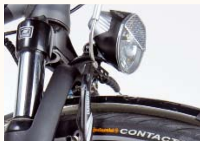
Sehr helle LED-Frontlampe – und chic dazu. Ebenfalls 1A-Wahl: die anti-pannentoptimierten Conti Contact Reifen. Unten: Der starke Green Mover Motor gehört zu den kultiviertesten auf dem Markt.
