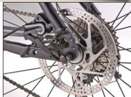
Ungewöhnlich groß: 180er Brems- scheibe für sichere Verzögerung
